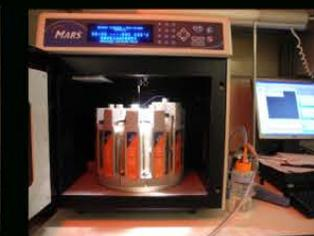
digestor de microondas
